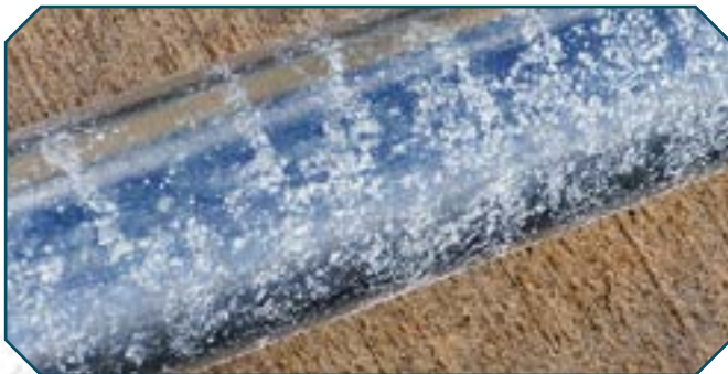
Ilustración 8: Mancha de oxidación por almacenamiento media
