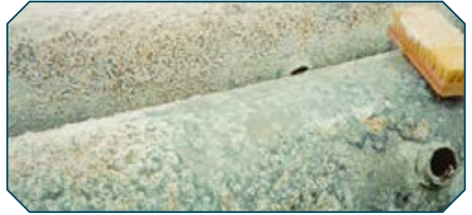
Ilustración 9: Mancha de oxidación por almacenamiento grave
