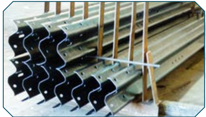
Ilustración 6: Almacenamiento de acero galvanizado con espaciadores para aumentar el aire de libre fluidez
